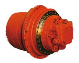
本产品为马达与减速机集成一体的行走装置独特的减速机构实现了小型轻量化,丰富的经验确保了高可靠性。马达内置安全阀、背压阀、停车制动器。具有传动比范围大、结构紧凑、体积小、重量轻、安装方便;传动效率高,运动平稳,噪音低;同时具有良好的安全保护,使用寿命长等优点。适用于开式液压系统,广泛应用于3.5~4吨液压挖掘机的行走装置。
